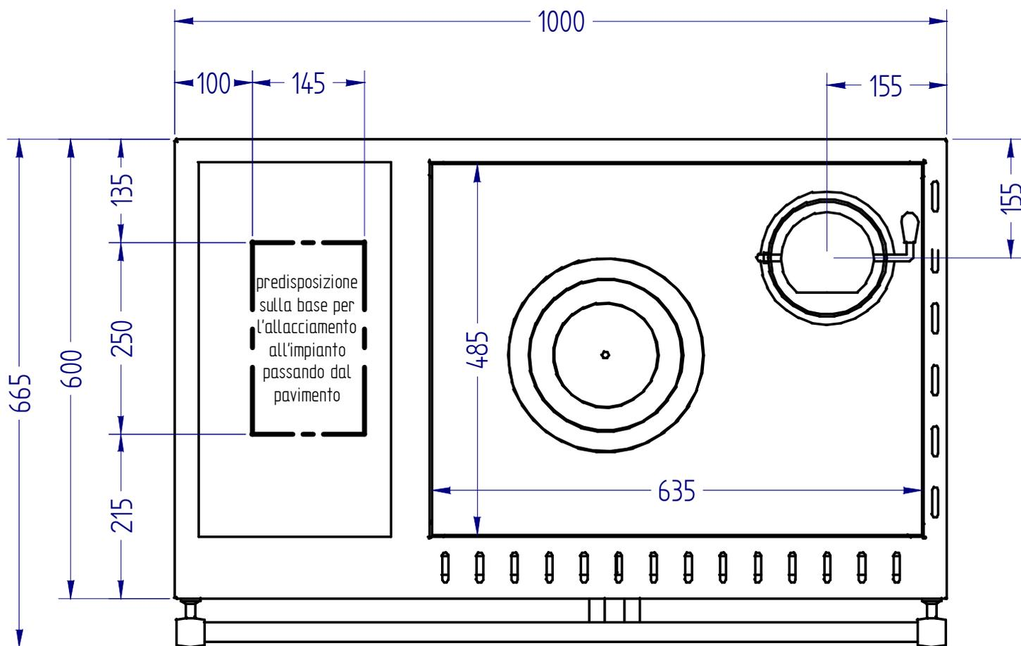
**Scheda tecnica possibile predisposizione attacchi a muro**
